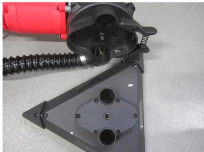
Installez et appuyez la machine sur le disque jusqu'à son verrouillage.
